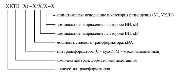
Пример записи условного обозначения КТП: КТП(М)-630-10/0,4-УХЛ1 — комплектная трансформаторная подстанция с одним масляным трансформатором мощностью 630 кВА, на номинальное напряжение 10/0,4 кВ, климатического исполнения УХЛ1.
