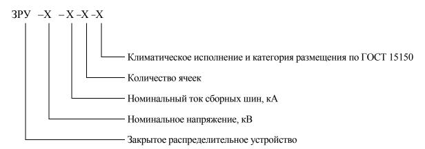
Пример записи условного обозначения ЗРУ-10-3150-8-УХЛ1 — закрытое распределительное устройство на номинальное напряжение 10 кВ, номинальный ток сборных шин 3150 A, с 8 ячейками, климатического исполнения УХЛ1.
